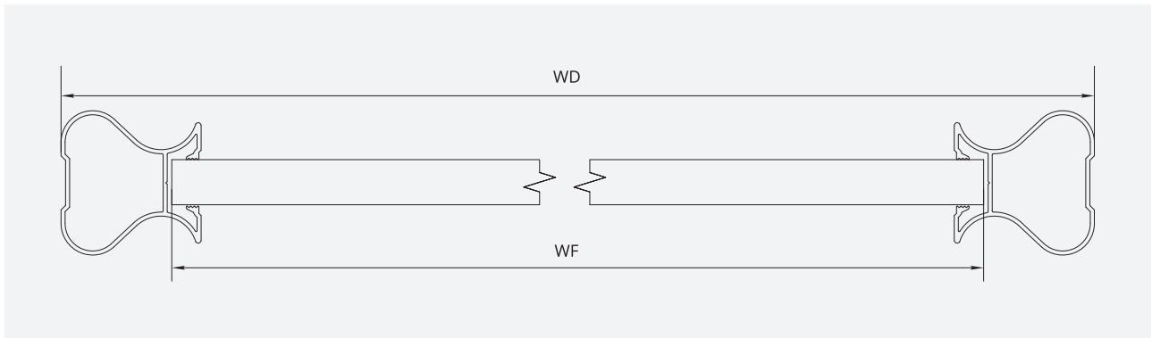
Сечение двери с наполнением из МДФ толщиной 8 мм
