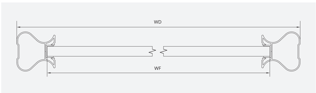
Сечение двери с наполнением из МДФ толщиной 8 мм
